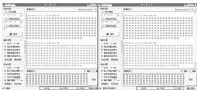
图9 网口与RS-422和LVDS数据透传测试图
